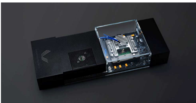
Рис. 5. Оптоэлектронный аппаратный ускоритель PACE от Lightelligence [28].
