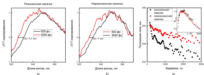
Рис. 2.17: а) - Спектры нормированного дифференциального пропускания в спектральной окрестности КВМ для двух задержек (черная линия - 500 фс, красная линия - 3000 фс) в случае резонансной накачки; б) - аналогичные спектры в случае нерезонансной накачки; в) - зависимости положения пика в спектре дифференциального пропускания от времени в случаях резонансной (черные точки) и нерезонансной (красные точки) накачки; вложение - нормированные зависимости амплитуд пиков от времени.
